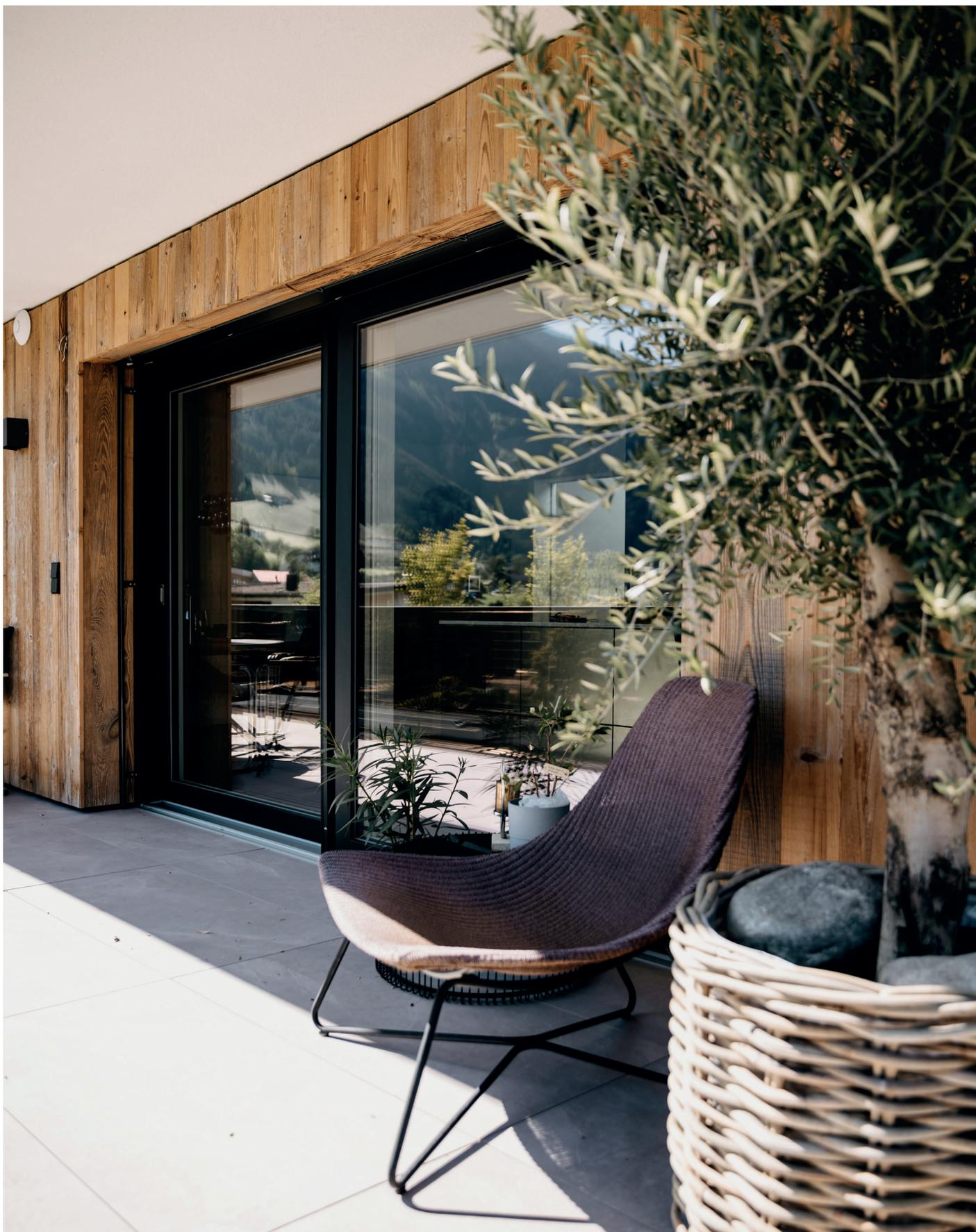
**WOHLFÜHLEN UND GENIEßEN.** Das **RIEDER HA78** bringt eine besondere Eigenschaft mit sich: der Baustoff Holz verleiht eine angenehme Wohnatmosphäre und außen ist die Aluschale pflegeleicht wie kein anderes Fenster. Diese Wärmedämmung wird durch eine Verglasung mit einem  $U_g$  Wert von  $0,5 \text{ W}/(\text{m}^2\text{K})$  erreicht.
